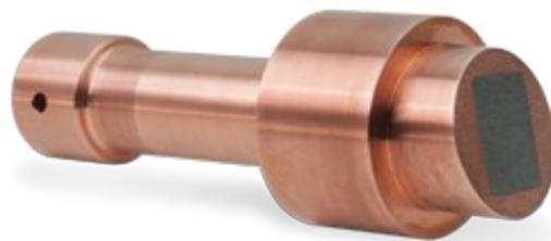
*En los tubos de rayos X con ánodo fijo, este suele estar construido con una base de cobre sobre la que se aplica una capa de wolframio en la zona de blanco.*
